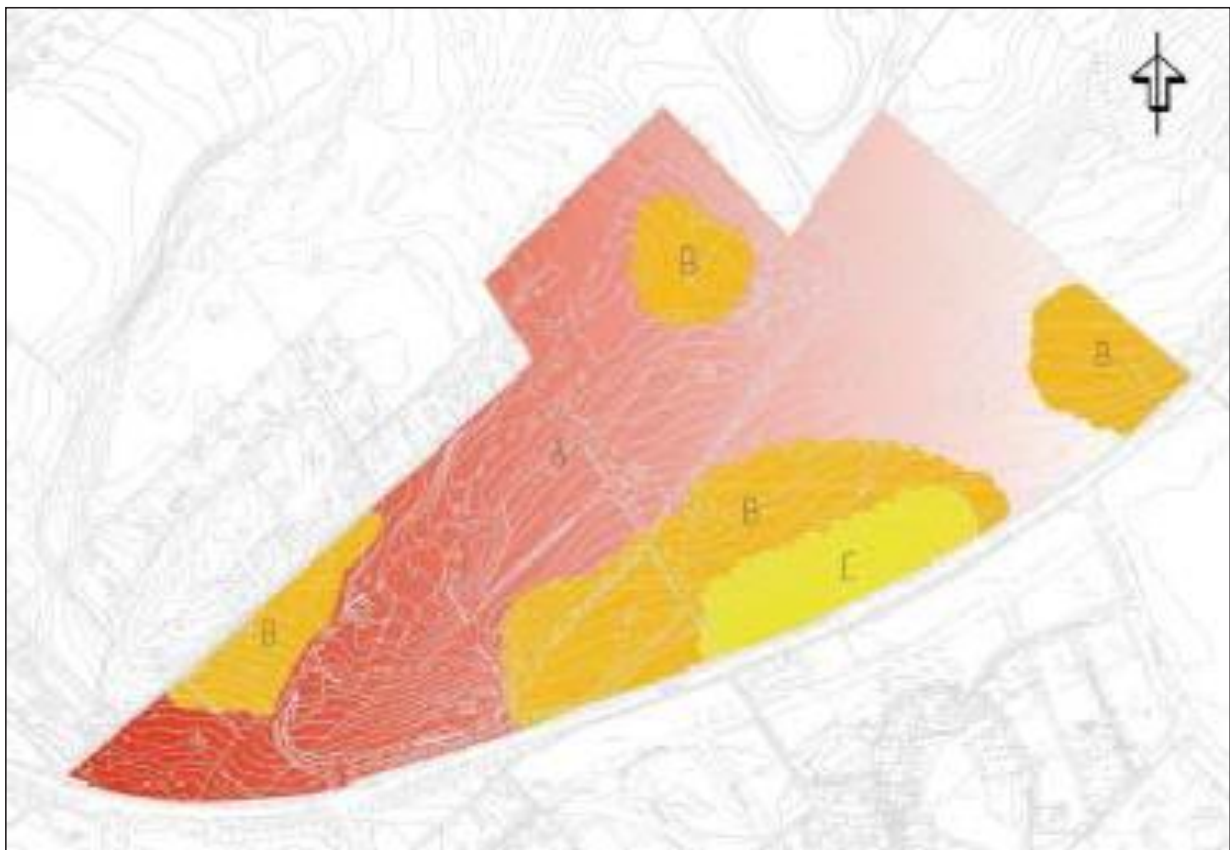
Delområden avseende geotekniska förhållanden. (bild från geoteknisk undersökning, WSP, 2010)
