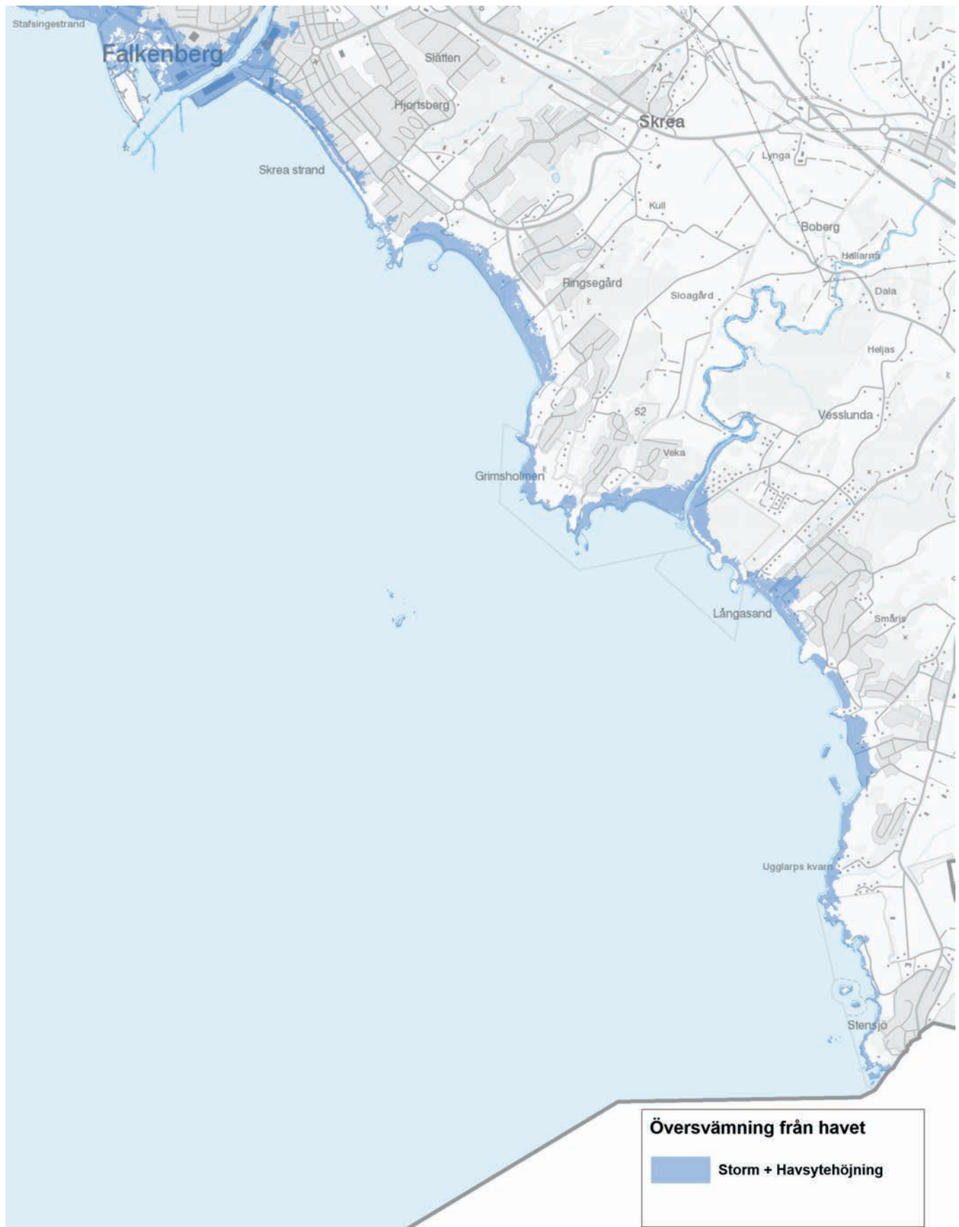
Figur 2 Bilden visar hur en havsytehöjning på ca en meter kombinerat med en storm från västlig sektor kan se ut för den södra kuststräckan i Falkenberg.
